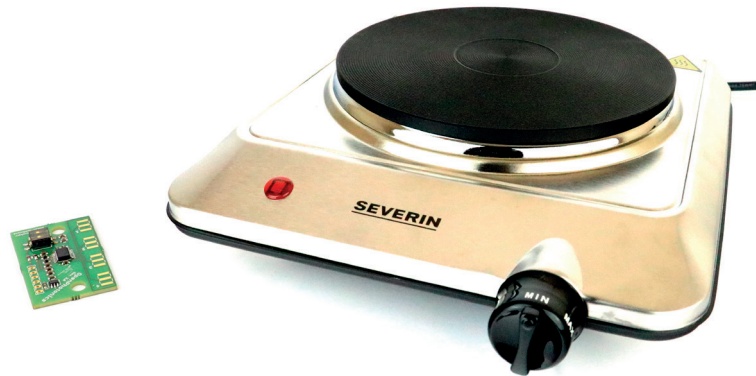
Abbildung 22: Foto der Herdplatte, mit der die SMD-Bauteile auf der Leiterplatte verlötet werden
